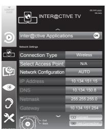
Select »Connection Type« with »V« or »A« and then select »Wireless« with »<« or »>«.
